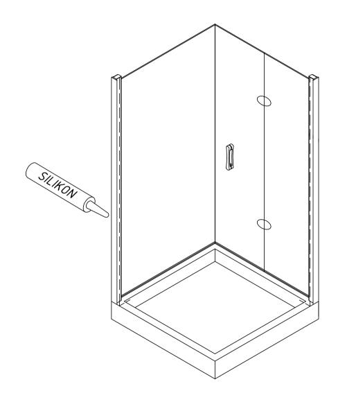
Надо понимать, что душевые ограждения не обеспечивают полной герметичности по периметру, а предназначены для защиты от брызг воды. При значительной нагрузке небольшое количество воды может вытечь наружу. Для улучшения герметичности возможна установка пороговой планки.
